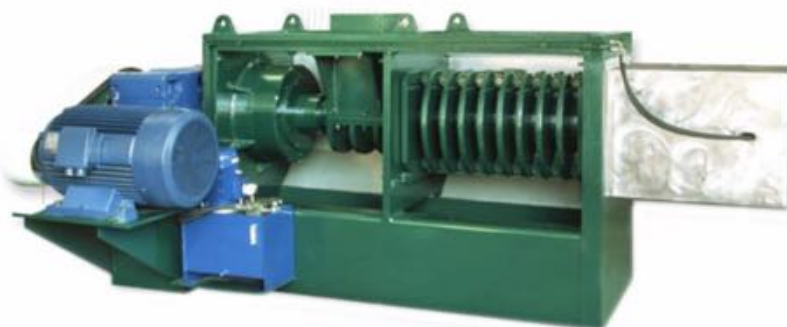
Figura 14: dettaglio costruttivo della filtopressa prevista nell'impianto: (marca "Carrera Impianti"- modello "M 1050").
