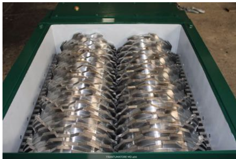
Figura 8: immagine di dettaglio del frantoio finitore (marca “Carrera Impianti” – modello “MD 400”).
