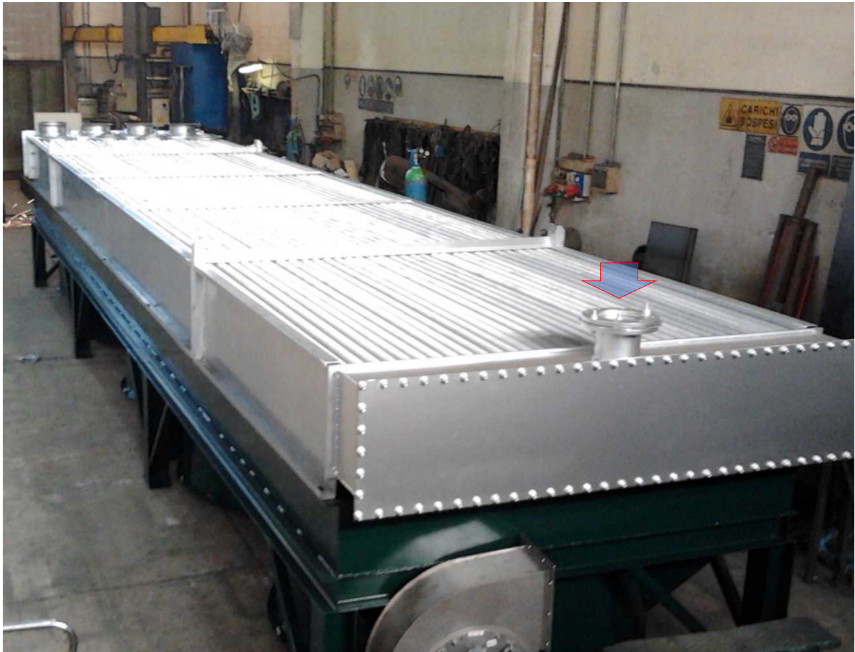
Figura 17: dettaglio dell'aerocondensatore, con il fascio tubiero esposto, e la flangia di connessione (indicata con la freccia) per l'evacuazione dei COV (gas incondensabili) alla batteria di Scrubber per la depurazione.
