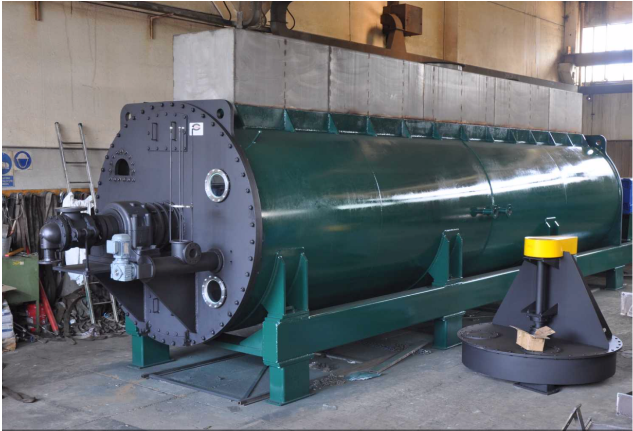
Figura n. 9 – immagine del cuocitore previsto per l'impianto da autorizzare Marca "Carrera Impianto" - modello CC 80.
