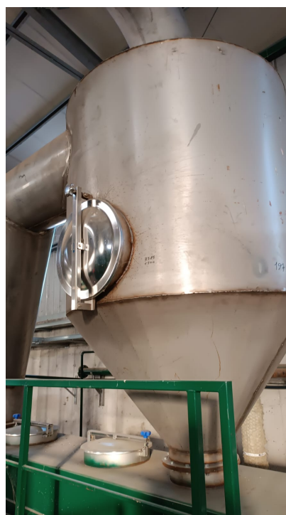
Figura n. 12 – immagine di dettaglio della cappa di aspirazione delle fumare dal cuocitore.
