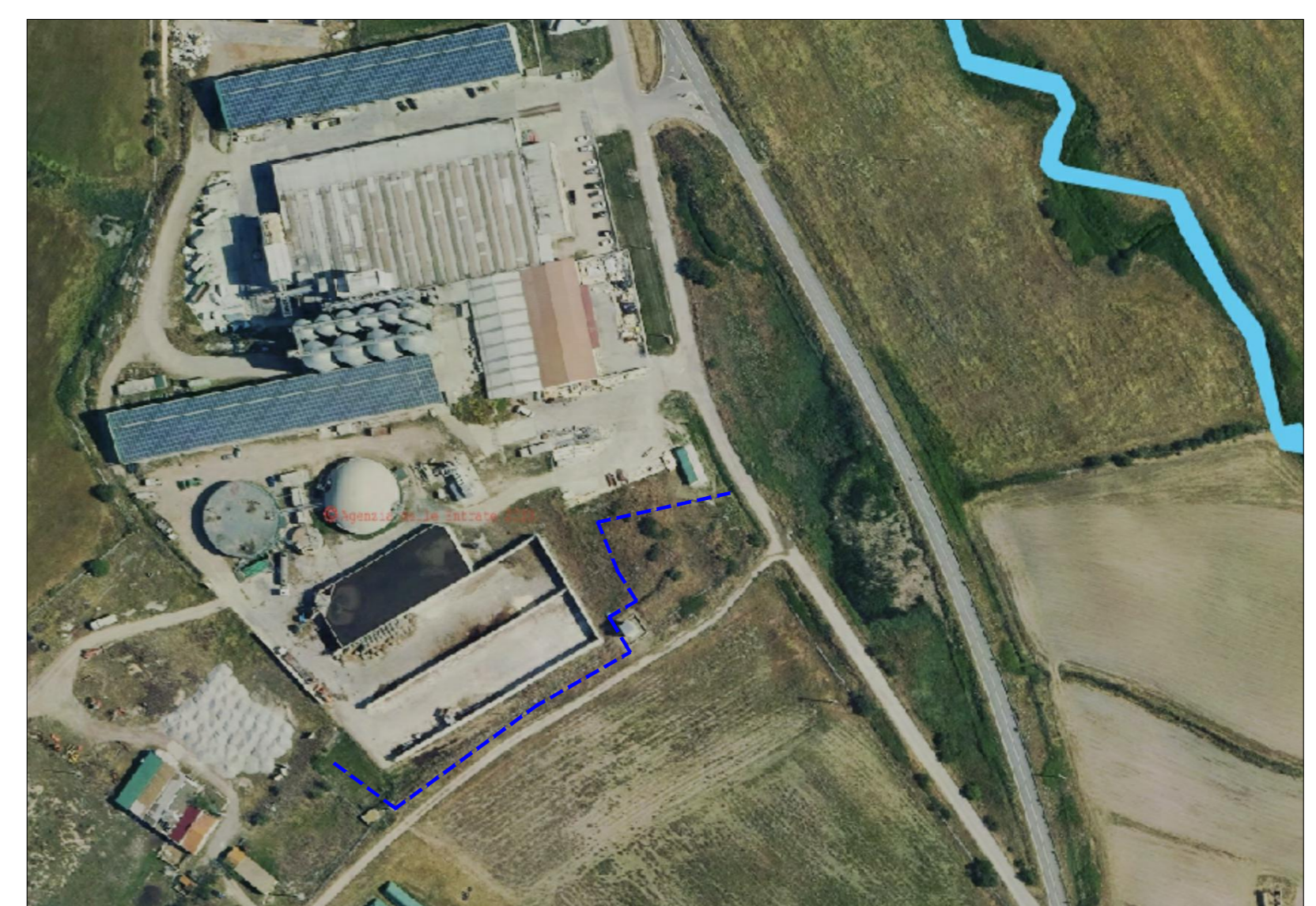
Ortofoto con indicazione tracciato tubazione acque seconda pioggia
