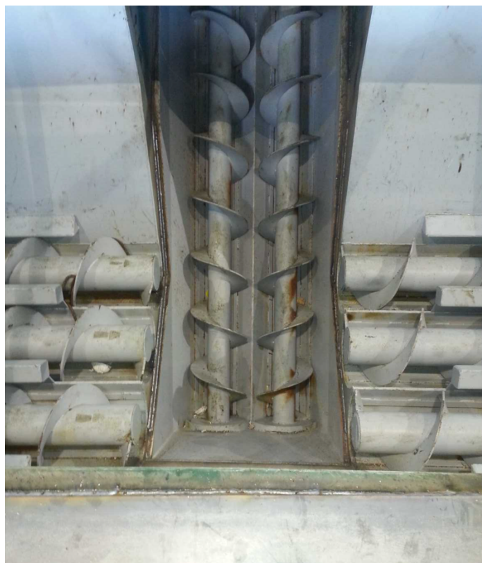
Figura 4: dettaglio delle coclee estrattrici poste all'interno della vasca di scarico dei SOA in ingresso all'impianto.
