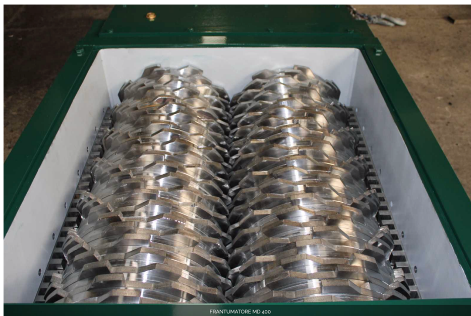
Figura 7: immagine di dettaglio del frantoio finitore (marca “Carrera Impianti” – modello “MD 400”).
