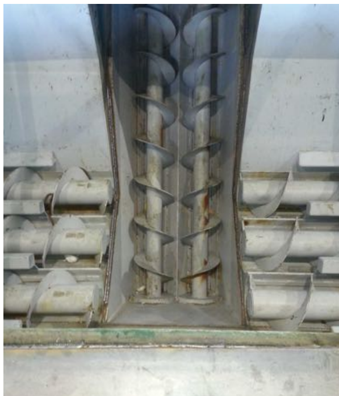
Figura 29: dettaglio delle coclee estraattrici poste all'interno della vasca di scarico dei SOA in ingresso all'impianto.
