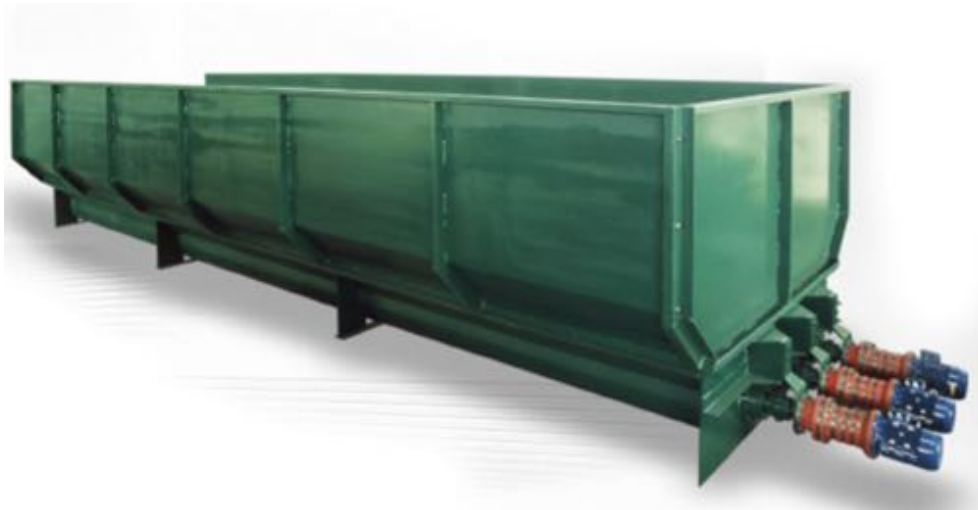
Figura 28: immagine della carpenteria della vasca di scarico dei SOA in arrivo all'impianto (dimensione netta: 10 x 3 x 1,2 metri).
