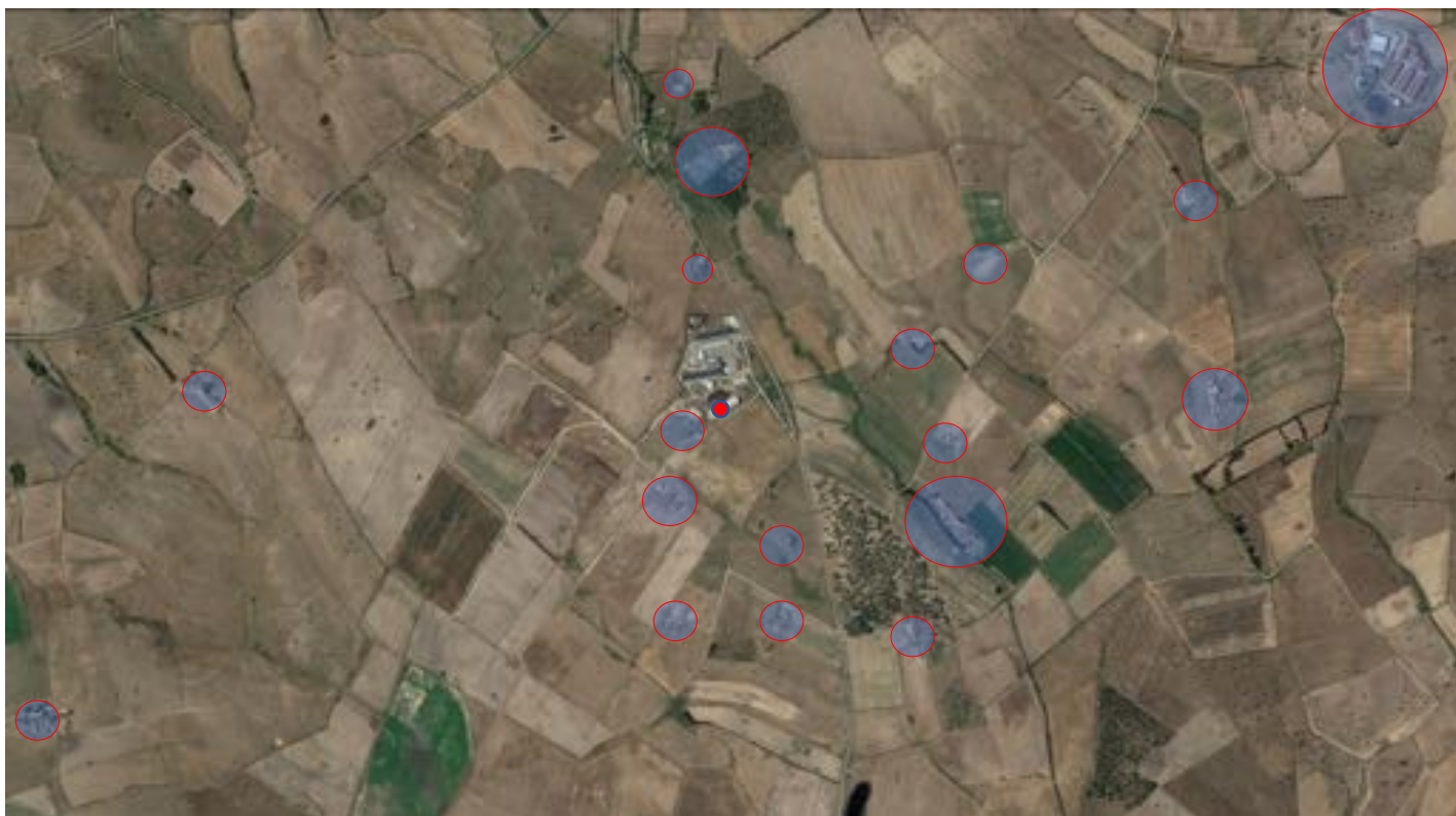
Figura 5: ortofoto con l'indicazione della sorgente (impianto di trattamento SOA – pallino in rosso) e tutti i bersagli potenziali delle ricadute odorogene presenti nel comprensorio (circa 1 Km 2 di superficie considerata)
