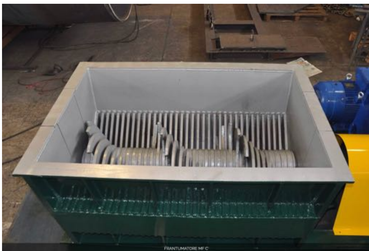
Figura 29: dettaglio delle coclee estraattrici poste all'interno della vasca di scarico dei SOA in ingresso all'impianto.
