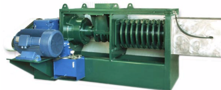
Figura 39: dettaglio costruttivo della filtropressa prevista nell'impianto: (marca "Carrera Impianti"- modello "M 1050").
