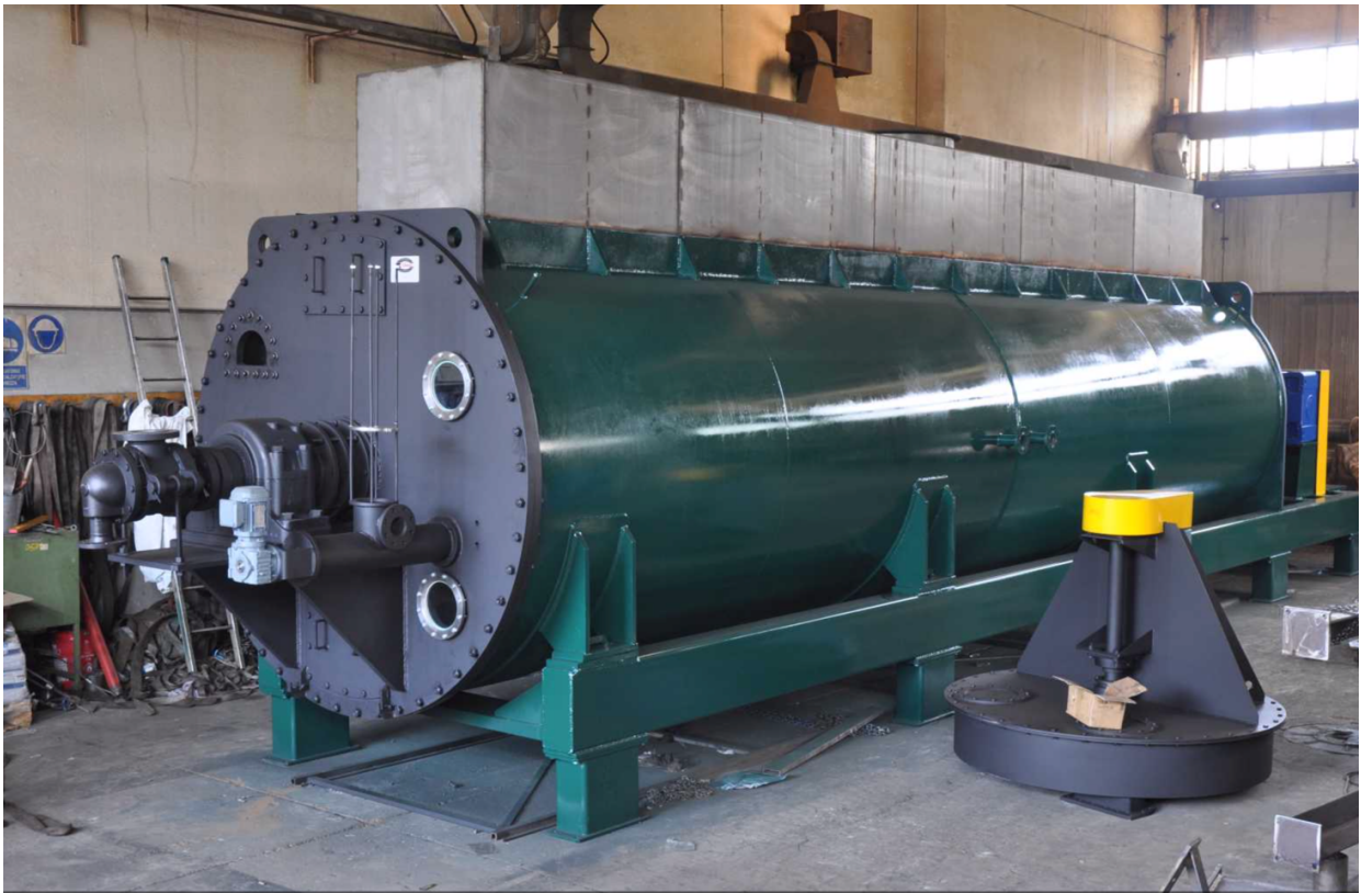
Figura 33: foto del cuocitore che verrà installato nell'impianto - Marca "Carrera Impianto" - modello CC 80.
