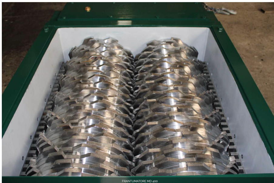
Figura 32: immagine di dettaglio del frantoio finitore (marca “Carrera Impianti” – modello “MD 400”).
