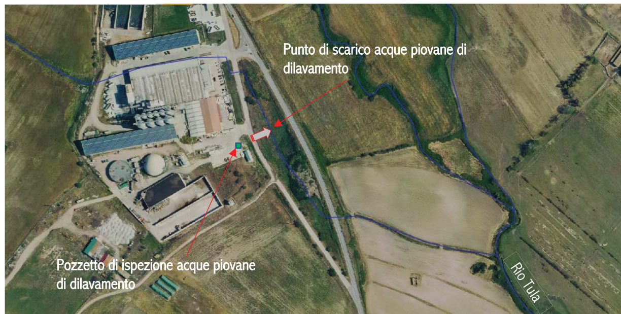
Figura 9: rappresentazione su ortofoto dell'idrografia della zona di studio (Rio Tula) con i riferimenti sulla posizione del pozzetto di ispezione per gli autocontrolli sulle acque piovane di dilavamento ricadenti all'interno della zona di impianto in progetto.
