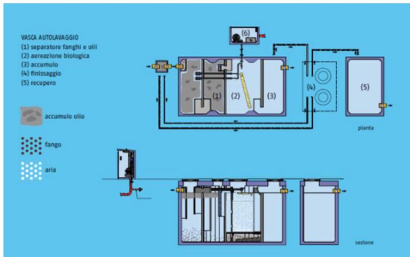
Figura 41: impianto di trattamento delle acque di lavaggio “zona sporca” e sanificazione mezzi.
