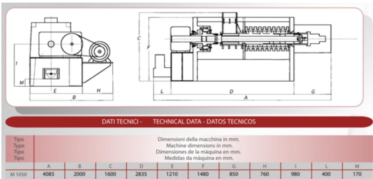
Figura 39: scheda tecnica filtropressa - (marca "Carrera Impianti"- modello "M 1050").
