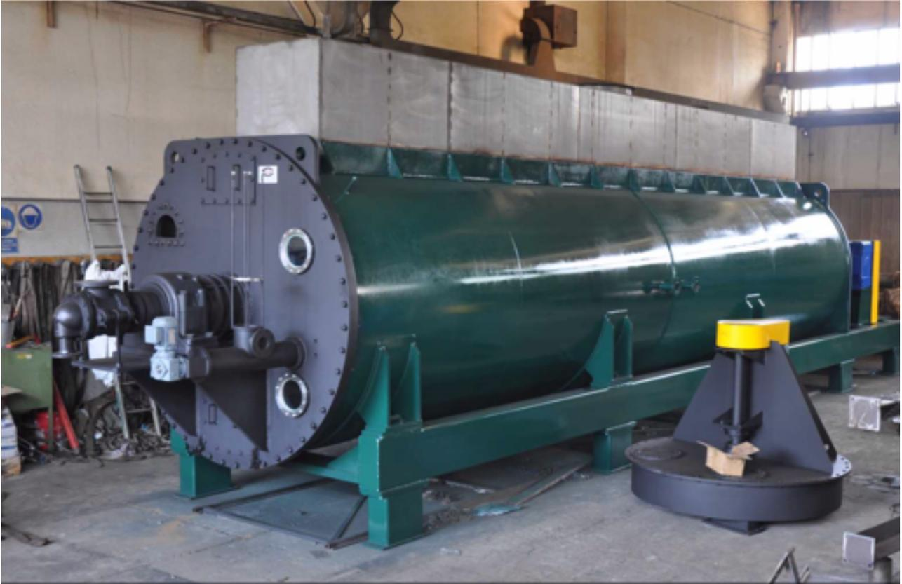
Figura 34: foto del cuocitore che verrà installato nell'impianto - Marca "Carrera Impianto" - modello CC 80.
