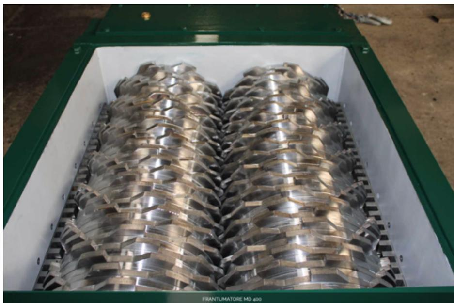
Figura 33: immagine di dettaglio del frantoio finitore (marca “Carrera Impianti” – modello “MD 400”).
