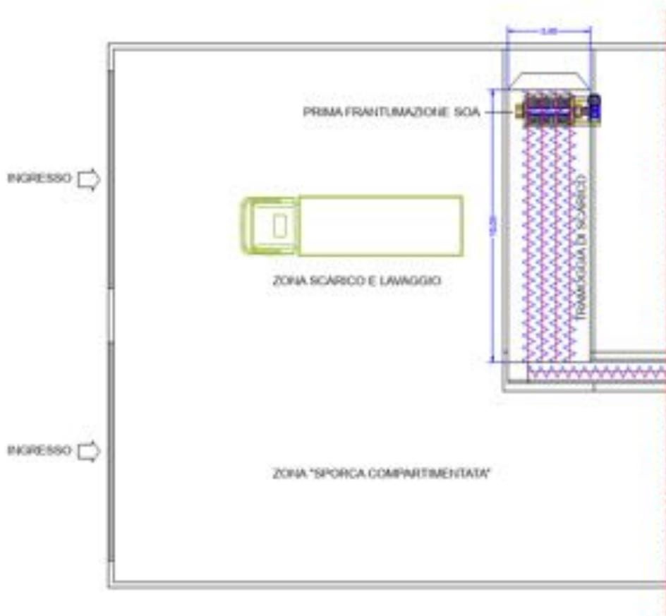
Figura 28: planimetria della zona "sporca" dell'impianto. Tramoggia di scarico.
