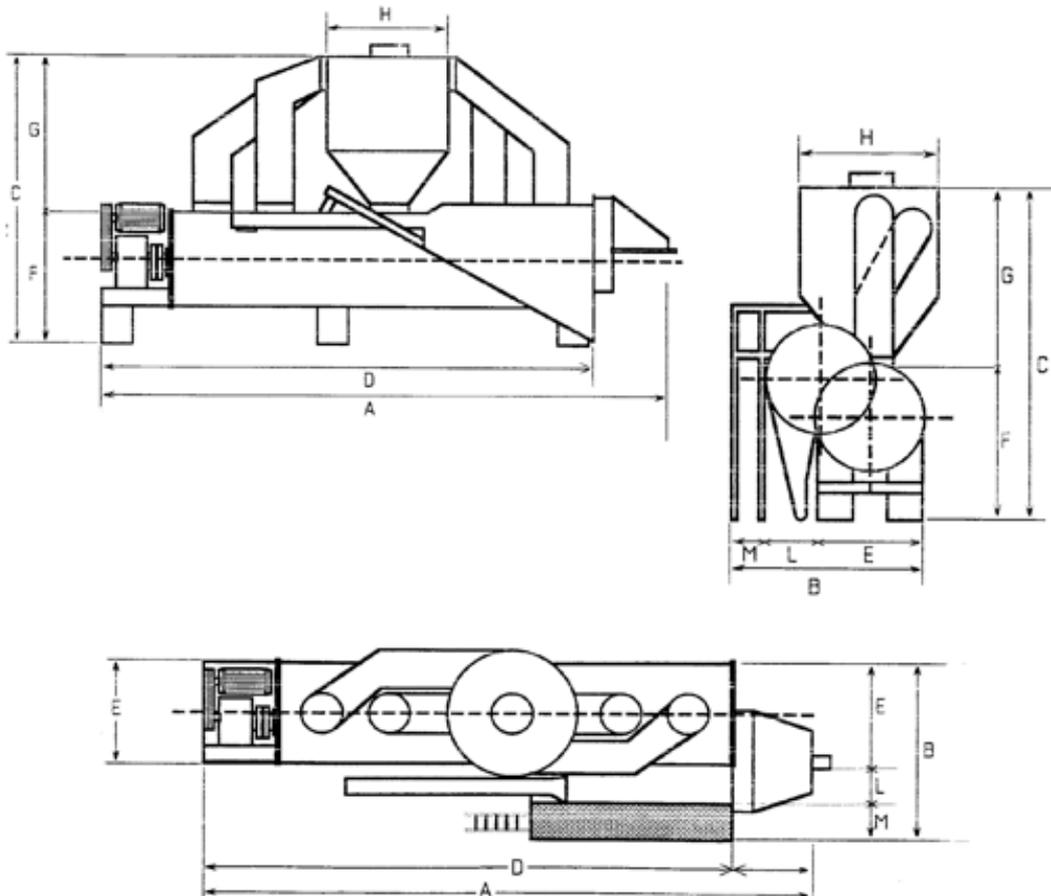
Figura 35: caratteristiche geometriche del cuocitore continuo.
