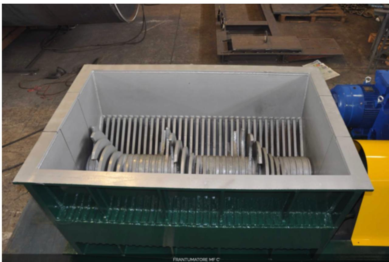
**Figura 31:** dettaglio costruttivo del frantumatore primario previsto in progetto (marca “Carrera Impianti” – modello “MFC 80”).
