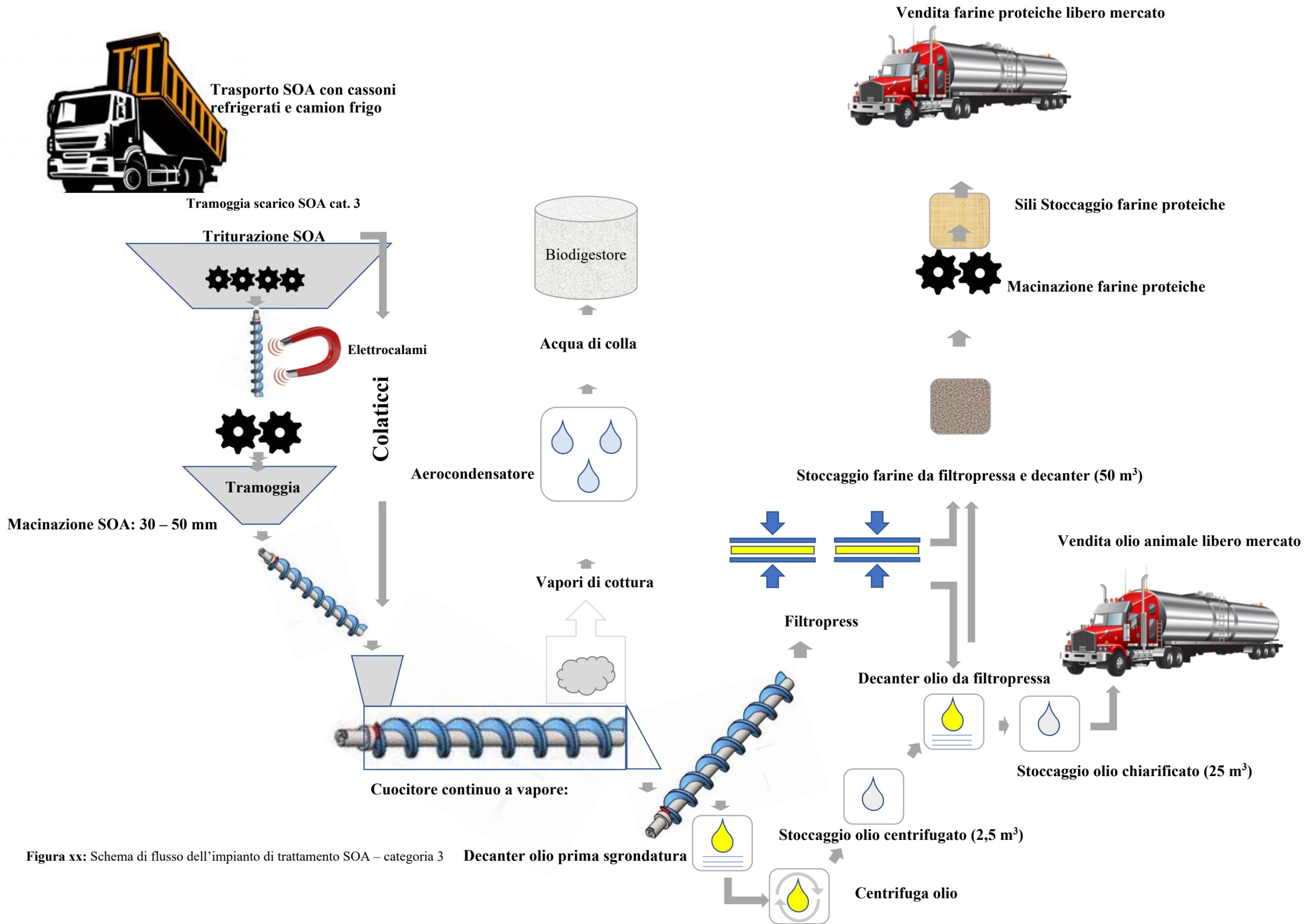
Figura xx: Schema di flusso dell'impianto di trattamento SOA – categoria 3
