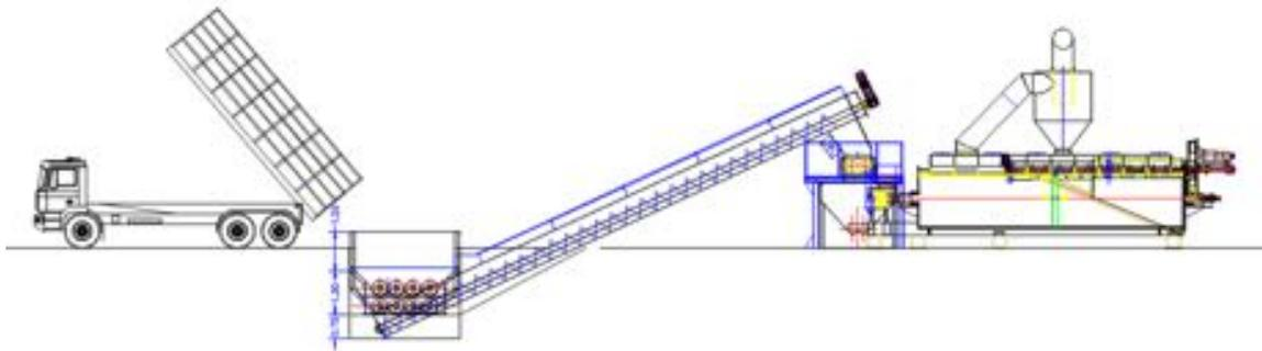
Figura 27: schema sezione impianto di ricevimento SOA. Tramoggia, trituratore primario, coclea di invio alla macinazione secondaria e cuocitore.
