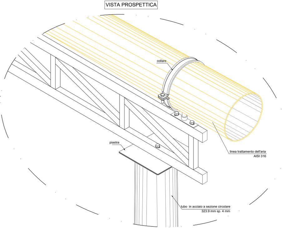
PROSPETTO TIPO SOSTEGNO TUBAZIONE ARIA
