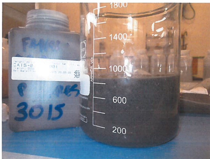
Foto 3 : Aliquota omogenea travasata nel becker graduato
