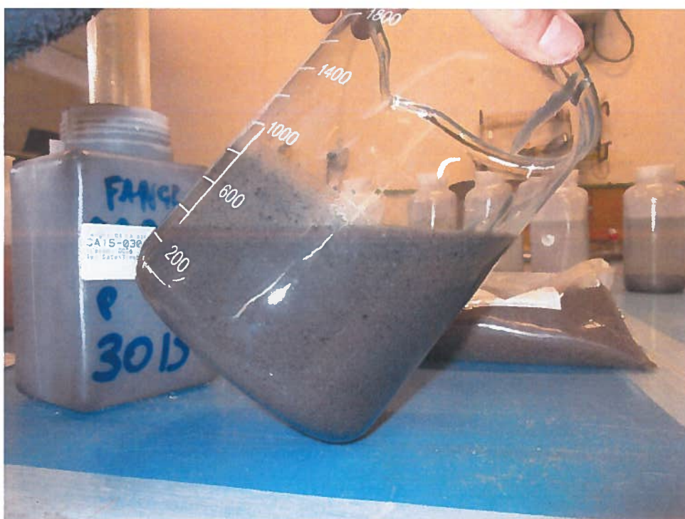
Foto 4 : Verifica omogeneità del campione
