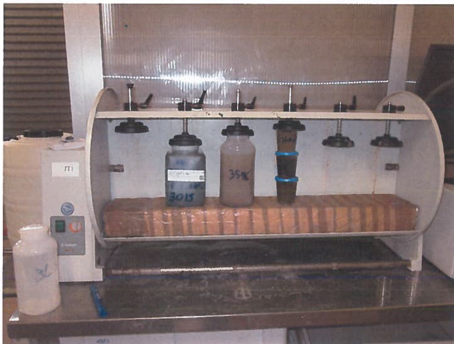
Foto 2 : Sistema di agitazione rotativa meccanica utilizzato per la fase di omogeneizzazione
