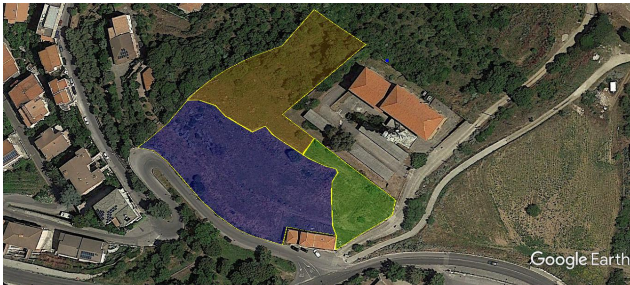
Fig. 20 - La scomposizione delle 3 superfici A, B e C diversamente orientate, con cui è stato rilevato il versante
